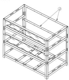
**6°** - Fixar peça K, travessa de apoio inferior das GPU's para as duas fileiras, conforme imagem abaixo.
